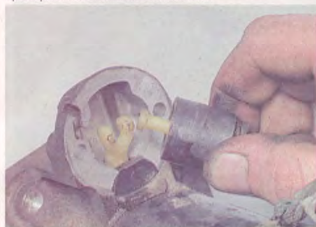
12. Осматриваем пружину втягивающего реле.
