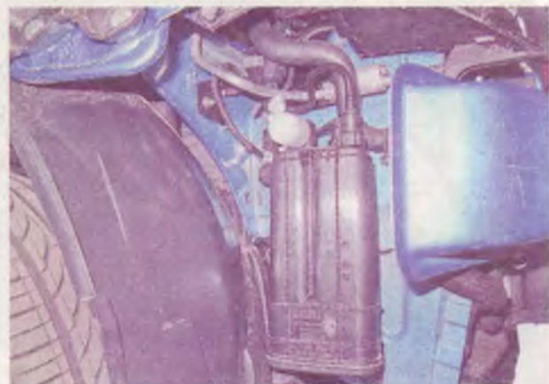
Клапан продувки адсорбера размещен в моторном отсеке справа.
