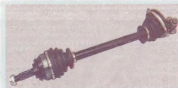
Привод левого переднего колеса в сборе
