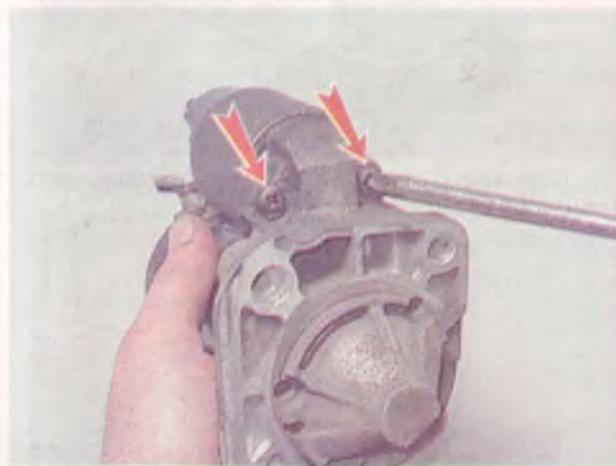
10. Снимаем корпус втягивающего реле.
