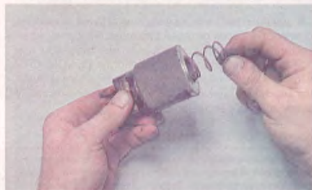
12. Осматриваем пружину втягивающего реле.
