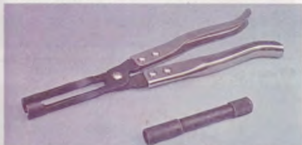
15. Рассухариватель для снятия клапанов механизма газораспределения.
