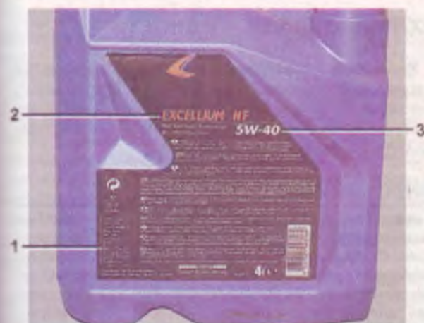
Пример маркировки масла на упаковке: 1 — маркировка соответствия масла техническим требованиям заводов изготовителей; 2 — название масла; 3 — маркировка вязкости масла
