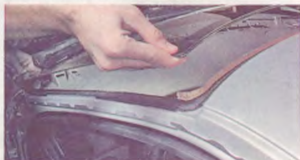
12. Снимаем стекло с автомобиля.
