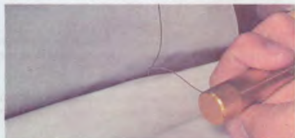
12. Снимаем стекло с автомобиля.
