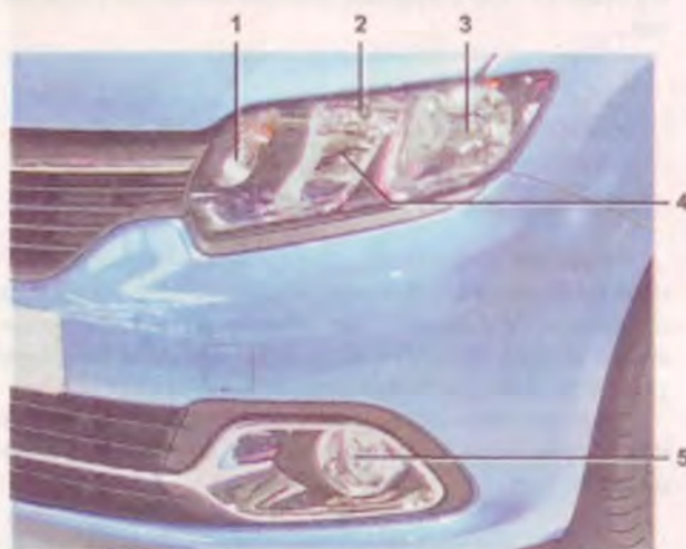
Расположение ламп в фарах: 1 — лампа указателя поворота; 2 — лампа дневного ходового огня и габаритного света; 3 — лампа ближнего света; 4 — лампа дальнего света; 5 — лампа противотуманной фары
