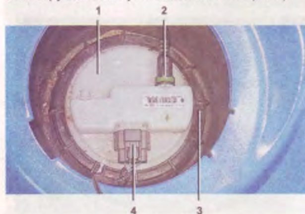
Топливный модуль: 1 — крышка топливного модуля; 2 — топливопровод; 3 — прижимное кольцо; 4 — электрический разъем
