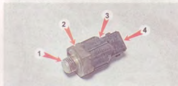
Датчик детонации: 1 — резьбовая часть датчика; 2 — шестигранная часть датчика под ключ; 3 — корпус датчика; 4 — выводы датчика для подсоединения колодки жгута проводов
