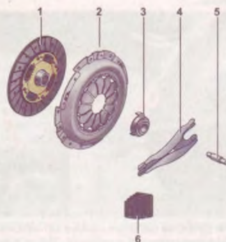
Детали сцепления: 1 — ведомый диск; 2 — нажимной диск в сборе (корзина); 3 — выжимной подшипник; 4 — вилка выключения сцепления; 5 — шарнир; 6 — чехол вилки
