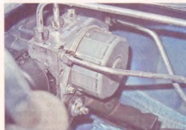
Гидроблок ABS
