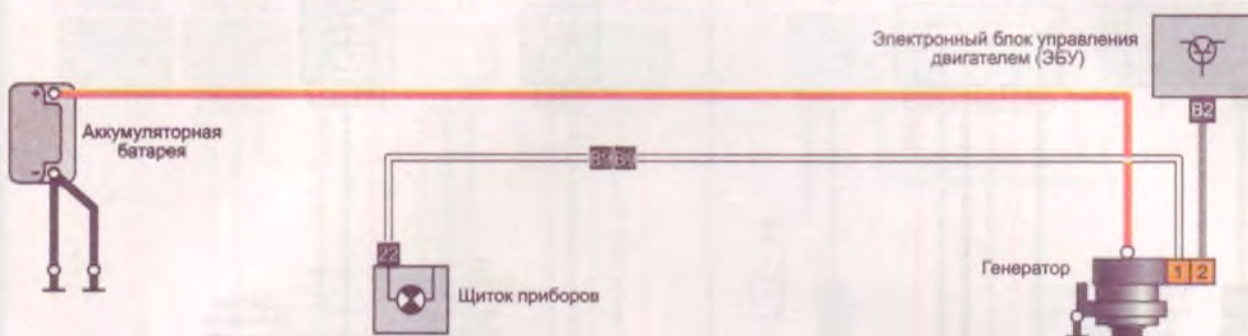
Схема 2. Система заряда аккумуляторной батареи для двигателя 1,6 8V K7M
