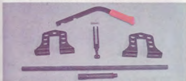
16. Съемник держателей обивки (пистонов).
