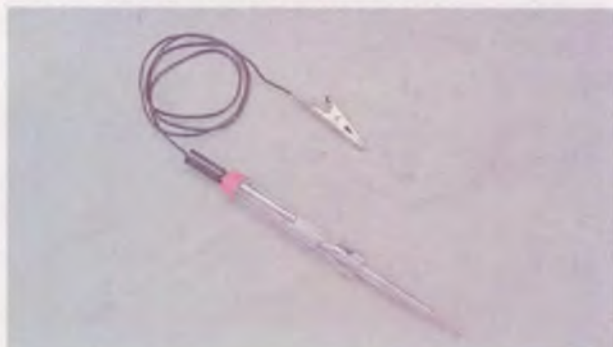
21. Специальный щуп или контрольная лампа на 12 В для проверки электрических цепей автомобиля, находящихся под напряжением.
