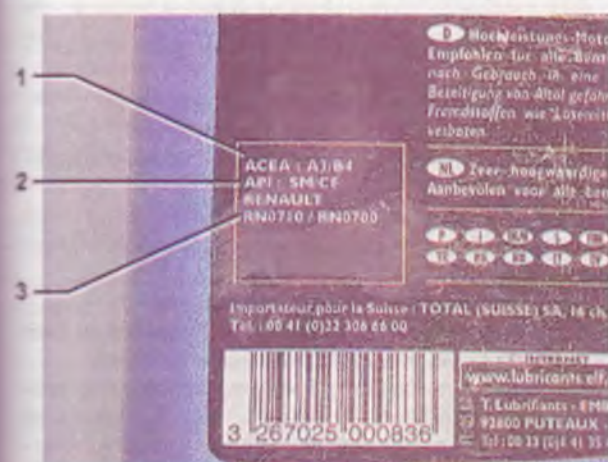
Пример маркировки соответствия моторного масла техническим требованиям европейских производителей: 1 — по нормам ACEA масло соответствует классу качества A3/B4; 2 — по нормам API масло соответствует классу качества SM/CF; 3 — маркировка соответствия требованиям автопроизводителя
