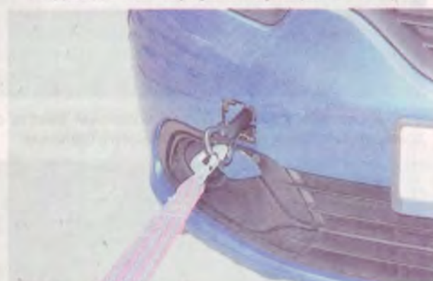
Подсоединяем к проушине буксировочный трос.
