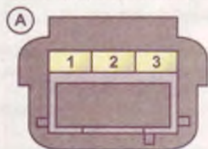
А. Выводы выключателя на автомобиле с ABS
