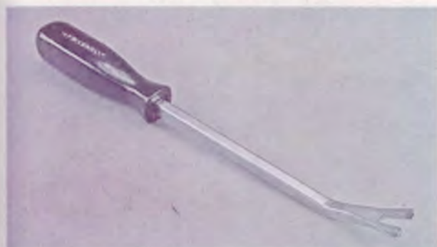
16. Съемник держателей обивки (пистонов).
