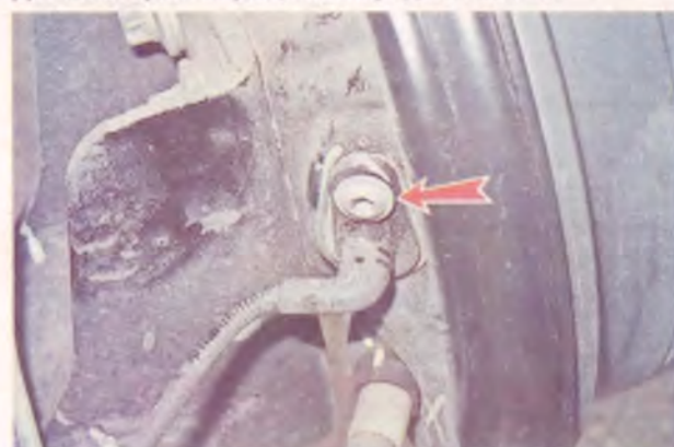
Датчик скорости вращения заднего колеса
