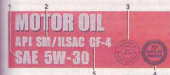
Пример маркировки соответствия моторного масла техническим требованиям международных стандартов: 1 — вязкость масла по SAE 5W-30; 2 — по нормам API масло соответствует классу качества SM; 3 — знак сертификации моторного масла API и SAE (API — обозначение классификации; SERVICE — масло для бензиновых двигателей; SM класс масла; SAE 5W-30 — класс вязкости; ENERGY CONSERVING II — масло обладает энергосберегающими свойствами; 4 — обозначение соответствия требованиям API и ILSAC; 5 — по нормам ILSAC масло соответствует классу GF-4
