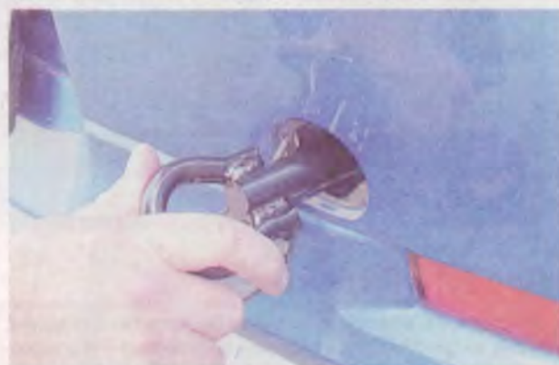
Подсоединяем к проушине буксировочный трос.
